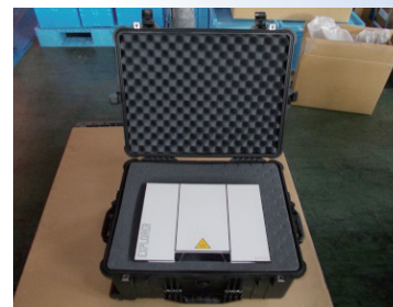
衛星通信装置（固定式）
