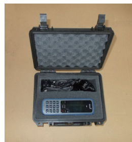
衛星通信装置（移動式）
